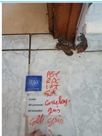
Matériaux : P061 Prélèvement : P061 Description : carrelage gris colle grise Localisation : RDC Résultat : Absence d'amiante
