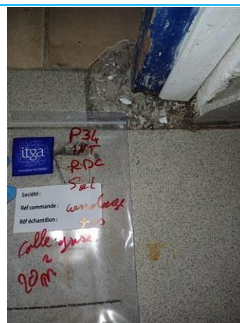
Matériaux : P034 Prélèvement : P034 Description : carrelage gris colle grise Localisation : RDC Résultat : Absence d'amiante
