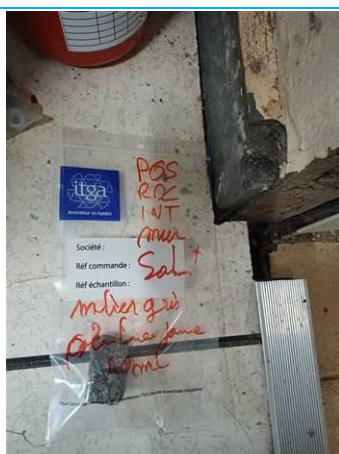
Matériaux : P065 Prélèvement : P065 Description : mortier gris peinture jaune Localisation : RDC- mur soubassement Résultat : Absence d'amiante
