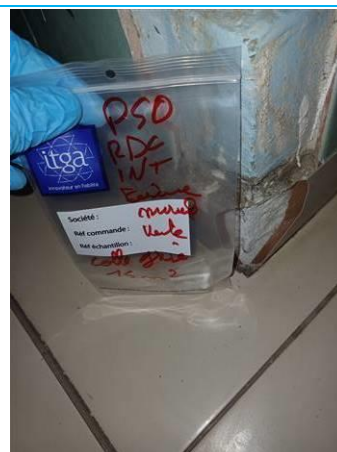
Matériaux : P050 Prélèvement : P050 Description : faïence verte colle grise Localisation : RDC Résultat : Absence d'amiante
