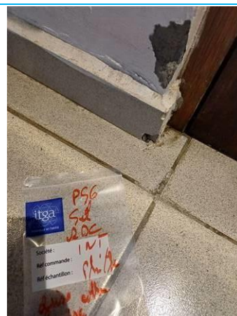
Matériaux : P056 Prélèvement : P056 Description : carrelage gris colle grise Localisation : RDC Résultat : Absence d'amiante
