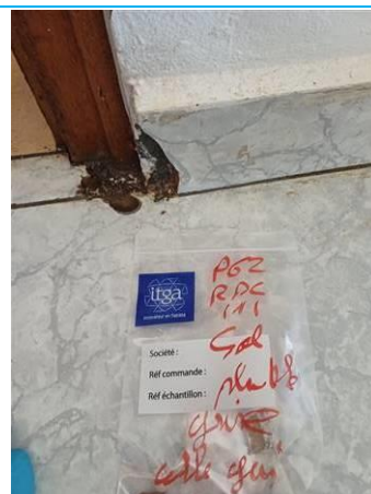
Matériaux : P062 Prélèvement : P062 Description : carrelage gris colle grise Localisation : RDC Résultat : Absence d'amiante
