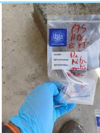
Matériaux : P075 Prélèvement : P075 Description : dé béton mortier gris poteau ext Localisation : RDC Résultat : Absence d'amiante
