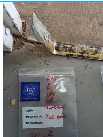
Matériaux : P028 Prélèvement : P028 Description : PVC gris Localisation : R+1 - sol bureau Résultat : Absence d'amiante
