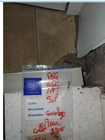
Matériaux : P064 Prélèvement : P064 Description : carrelage brun colle grise Localisation : RDC Résultat : Absence d'amiante
