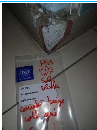
Matériaux : P049 Prélèvement : P049 Description : carrelage beige colle grise Localisation : RDC Résultat : Absence d'amiante
