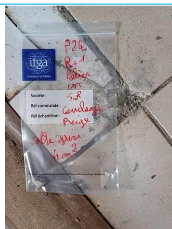
Matériaux : P024 Prélèvement : P024 Description : carrelage beige colle grise Localisation : R+1 Résultat : Absence d'amiante
