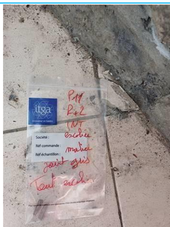
Matériaux : P011 Prélèvement : P011 Description : mortier joint gris escalier Localisation : R+2 Résultat : Absence d'amiante
