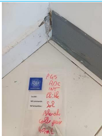
Matériaux : P045 Prélèvement : P045 Description : carrelage blanc colle grise Localisation : RDC Résultat : Absence d'amiante
