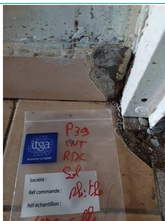
Matériaux : P039 Prélèvement : P039 Description : carrelage rose colle grise Localisation : RDC Résultat : Absence d'amiante
