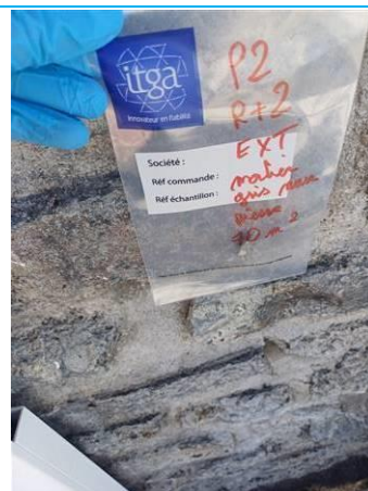
Matériaux : P002 Prélèvement : P002 Description : mortier gris sur mur en pierre Localisation : R+2 Résultat : Absence d'amiante
