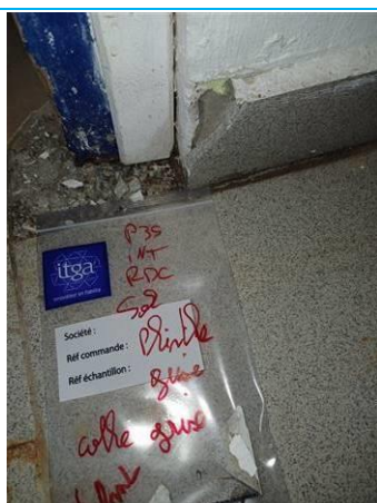
Matériaux : P035 Prélèvement : P035 Description : carrelage gris colle grise Localisation : RDC Résultat : Absence d'amiante
