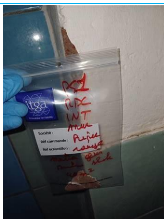
Matériaux : P051 Prélèvement : P051 Description : brique rouge mortier gris peinture blanche Localisation : RDC Résultat : Absence d'amiante
