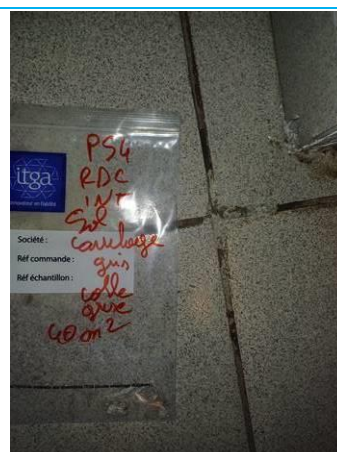
Matériaux : P054 Prélèvement : P054 Description : carrelage gris colle grise Localisation : RDC Résultat : Absence d'amiante
