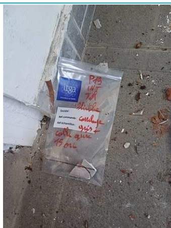
Matériaux : P019 Prélèvement : P019 Description : carrelage gris colle grise Localisation : Demi Palier Résultat : Absence d'amiante
