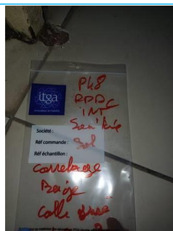
Matériaux : P048 Prélèvement : P048 Description : carrelage beige colle grise Localisation : RDC -sol sanitaire Résultat : Absence d'amiante
