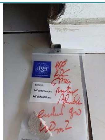
Matériaux : P060 Prélèvement : P060 Description : peinture blanche enduit gris Localisation : RDC Résultat : Absence d'amiante
