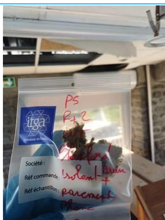
Matériaux : P005 Prélèvement : P005 Description : isolant brun parement blanc Localisation : R+2 Résultat : Absence d'amiante
