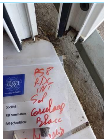
Matériaux : P058 Prélèvement : P058 Description : carrelage blanc colle grise Localisation : RDC Résultat : Absence d'amiante
