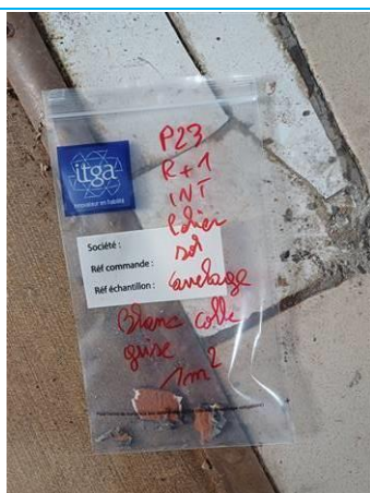
Matériaux : P023 Prélèvement : P023 Description : carrelage blanc colle grise Localisation : R+1 - sol palier Résultat : Absence d'amiante
