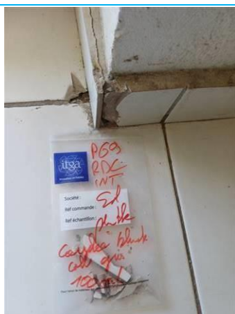
Matériaux : P069 Prélèvement : P069 Description : carrelage blanc colle grise Localisation : RDC Résultat : Absence d'amiante
