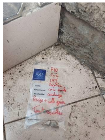
Matériaux : P010 Prélèvement : P010 Description : carrelage beige colle grise escalier Localisation : R+2 Résultat : Absence d'amiante
