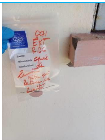
Matériaux : P071 Prélèvement : P071 Description : béton gris peinture rose sur appui de fenêtre extérieur Localisation : RDC Résultat : Absence d'amiante
