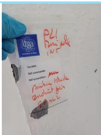
Matériaux : P021 Prélèvement : P021 Description : peinture blanche enduit gris Localisation : Demi Palier Résultat : Absence d'amiante
