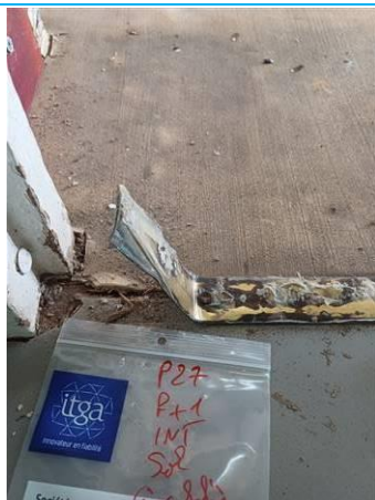
Matériaux : P027 Prélèvement : P027 Description : pvc brun Localisation : R+1 - sol bureau Résultat : Absence d'amiante
