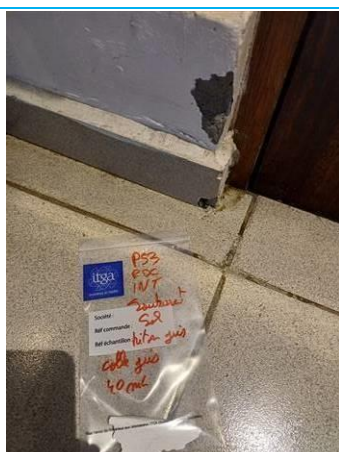
Matériaux : P053 Prélèvement : P053 Description : béton gris colle grise sol soubassement Localisation : RDC Résultat : Absence d'amiante
