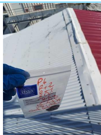
Matériaux : P004 Prélèvement : P004 Description : toiture joint et étanchéité vis peinture blanche Localisation : R+2 Résultat : Absence d'amiante
