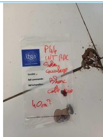
Matériaux : P044 Prélèvement : P044 Description : carrelage blanc colle grise Localisation : RDC Résultat : Absence d'amiante
