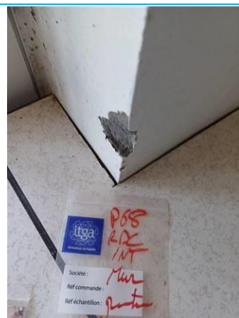
Matériaux : P068 Prélèvement : P068 Description : peinture blanche enduit gris Localisation : RDC Résultat : Absence d'amiante
