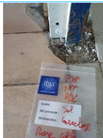
Matériaux : P038 Prélèvement : P038 Description : carrelage rose colle grise Localisation : RDC Résultat : Absence d'amiante
