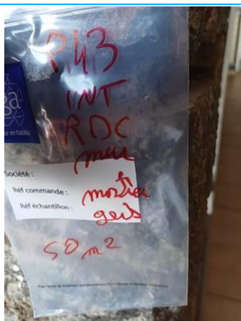
Matériaux : P043 Prélèvement : P043 Description : mortier gris mur pierre Localisation : RDC Résultat : Absence d'amiante
