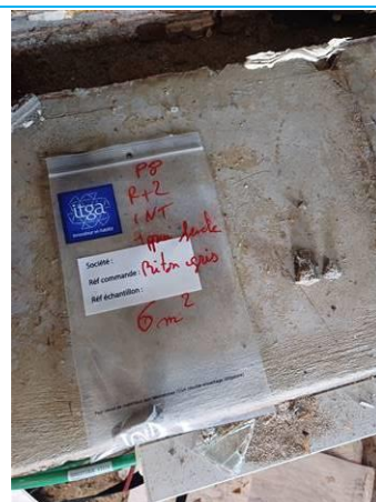
Matériaux : P008 Prélèvement : P008 Description : béton gris appui fenêtre Localisation : R+2 Résultat : Absence d'amiante
