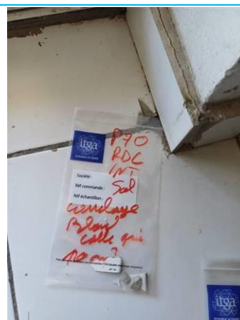
Matériaux : P070 Prélèvement : P070 Description : carrelage blanc colle grise Localisation : RDC Résultat : Absence d'amiante
