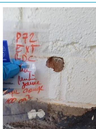
Matériaux : P072 Prélèvement : P072 Description : peinture jaune sur brique rouge Localisation : RDC Résultat : Absence d'amiante
