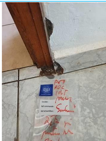
Matériaux : P063 Prélèvement : P063 Description : béton gris peinture blanche Localisation : RDC - mur soubassement Résultat : Absence d'amiante
